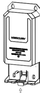
将螺钉锁入背面的螺孔
